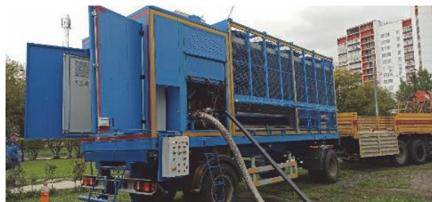
Мобильная установка для воздушного охлаждения трубопроводов
